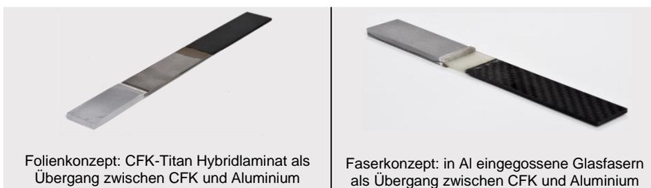
Gemeinsames Ziel der Forschergruppe ist es, eine Aussage über die Wechselwirkungen verschiedener Einflüsse in der Prozesskette sowie eine Aussage über die Leistungsfähigkeit der Verbindungen unter verschiedenen Lastfällen zu treffen. Hierzu werden die Verbindungen umfassend mechanisch charakterisiert.
